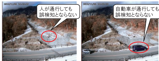
図6 人・自動車通行時の誤検知回避の事例
