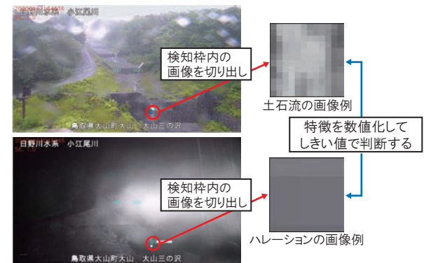
図9 画像特徴量の数値化による誤検知対策
