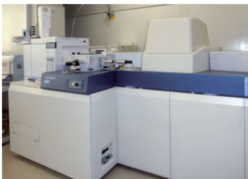
写真1 GC/HRMS(高分解能ガスクロマトグラフ質量分析計)
