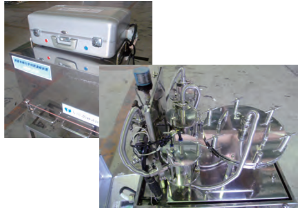
写真2 微量有機化学物質濃縮装置
