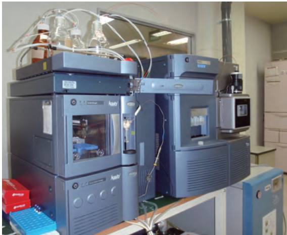
写真3 UHPLC/MS/MS (超高速液体クロマトグラフタンデム質量分析計)
