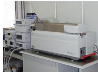
液体クロマトグラフタンデム型質量分析計(LC/MS/MS)
