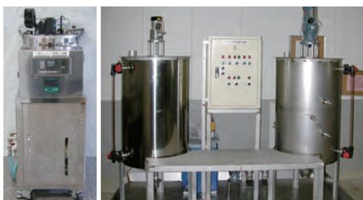
ホルマリン処理装置(左:小型、右:大型)
