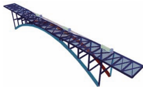
図1 車輦走行による振動予測シミュレーション
