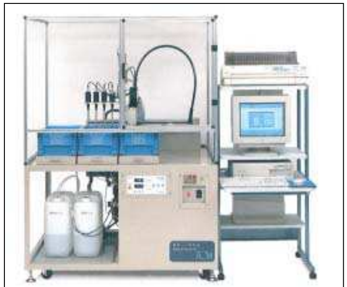
BOD 自動測定装置 処理能力：1,100 本/約 6 時間 溶存酸素（DO）を自動測定 BOD 値を自動演算・印字
