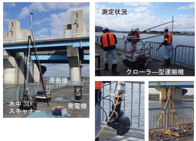
図 1 開発したロボット (左) と 水中 3D スキャナー (中), 3D レーザースキャナー (右)
