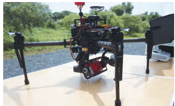
写真1 マルチスペクトルカメラを搭載したドローン
