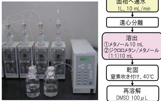
図4 固相抽出法の流れと定流量ポンプ
