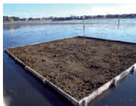
写真5 底質改良試験
