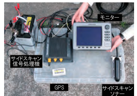
写真1 本事例に用いた簡易型サイドスキャンソナー(HDS-8型 LOWLANCE社製)
