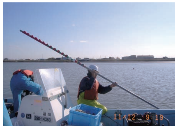
写真2 河床変動モニタリング装置の外観
