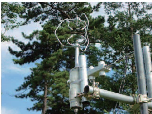
熱収支の測定風景（超音波風速計、長短波放射計）
