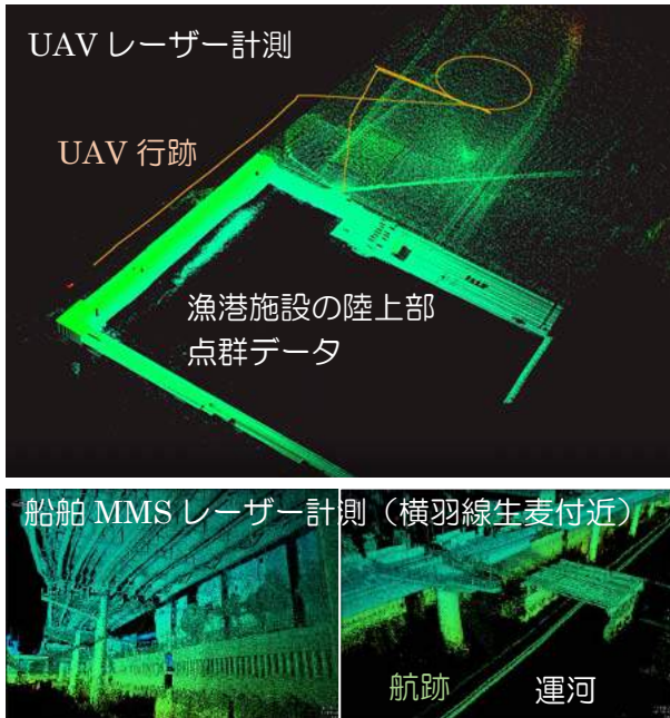
図 22 レーザーによる陸上部の 3D 計測事例
