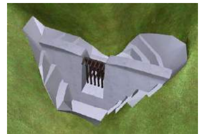
図-5 設計-施工モデル（土工形状+堰堤）
