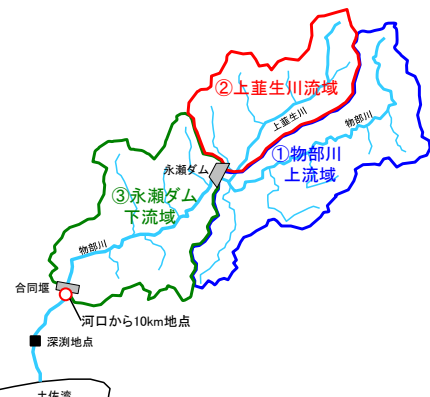
図-12 土砂の発生場所を設定するための流域分割
