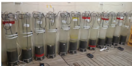
写真3 恒温実験室における静置式溶出試験
