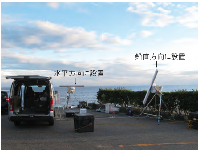
写真3 船舶レーダ設置状況
