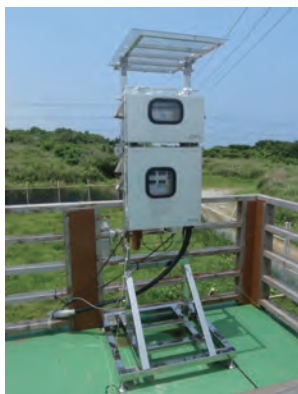
写真1 大気中水銀の連続モニタリング
