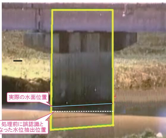
図5 夜間における水位計測実施例(Retinexモデル適用前)
