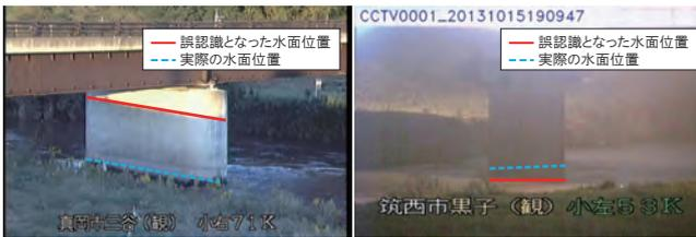
図4 水位計測時に誤認識となった撮影映像事例
