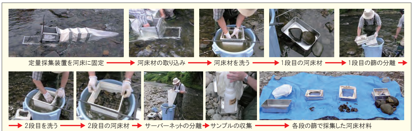
図2 新たな定量採集装置による具体的な作業の流れ
