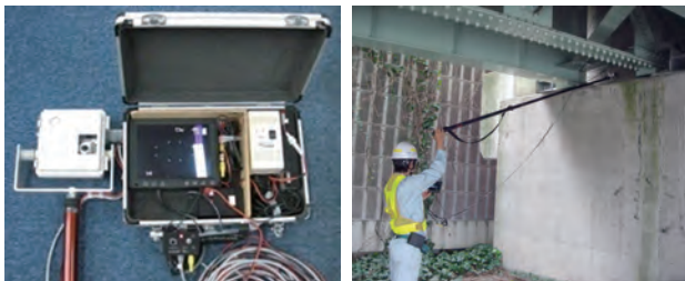
写真1 リモートモニターカメラによる点検 (左:リモートモニターカメラ機材 右:支承の確認状況)
