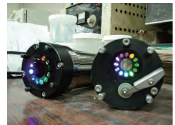
写真2 多波長励起蛍光光度計
