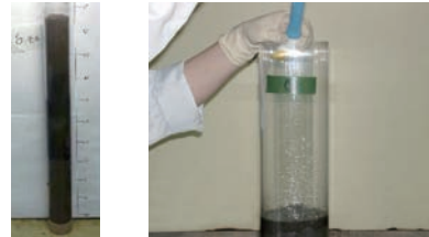
写真1 汚染土壌の不溶化のためのカラム実験(左)と散布をイメージした不溶化剤の添加状況(右)
