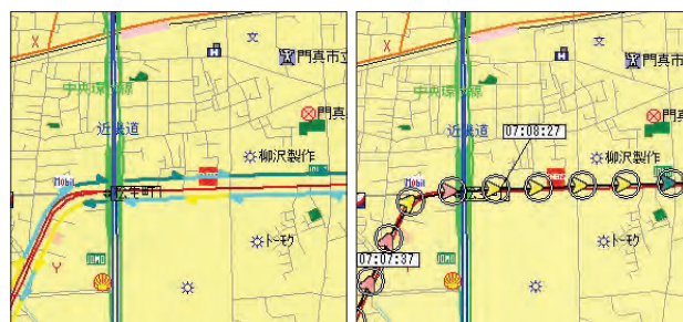
図2 DRM上の車の軌跡(左)とプローブデータの取得地点(右) (左図の特定コースに沿った点データの取得地点を、右図の◎印で示す)
