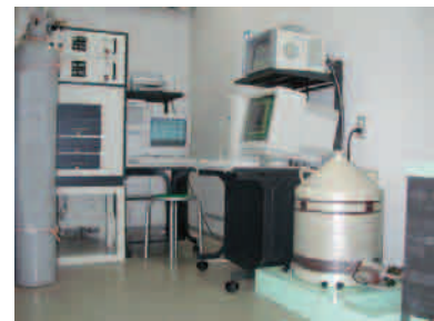
図2 向かって左側:β線測定装置 向かって右側:γ線測定装置
