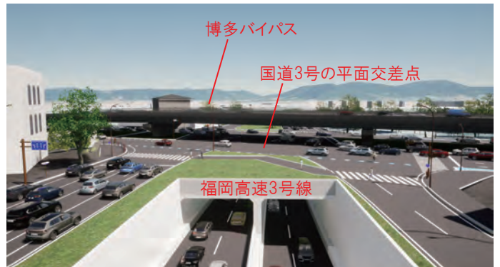
図2 空港口交差点部の3階建て構造
