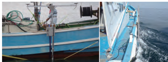
写真1 マルチビームソナーの機装(左)と海底探査調査(右)
