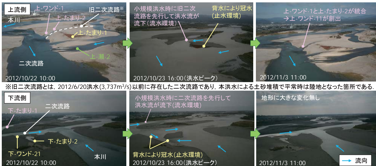
図-5 小規模洪水の連続撮影画像と洪水時流れの特性 (2012年10月22日～11月3日)
