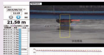
CCTVカメラによる河川水位計測システム
