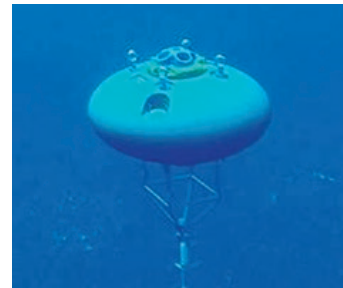
流速と波浪の計測状況
