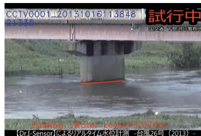
システムによるリアルタイム水位計測の状況
