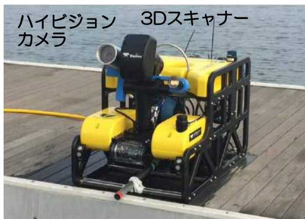
水中3Dスキャナー搭載ROV
